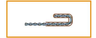
对于小丝小孔的筛网,丝径不超过1mm,折弯角度根据规格而定。
